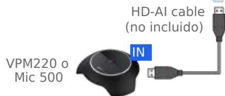
Siempre y cuando el cable esté conectado, el micrófono externo puede captar sonido. No se requieren parámetros de configuración.
